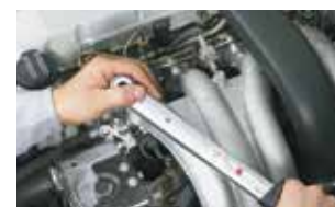
Demontage und Montage von Glühkerzen grundsätzlich mit einem Drehmomentschlüssel durchführen.
