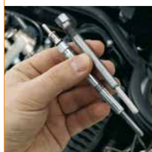
Die BERU Reibahle (RA003) löst Verkokungen, die nach dem „Verbacken“ zwischen Glühkerze und Zylinderkopf entstehen können.
