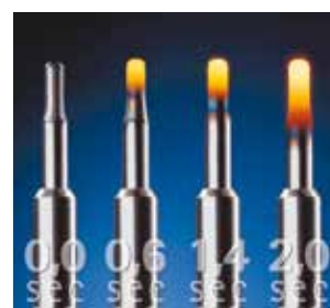
Das BERU Instant Start System ermöglicht einen „ottomotorischen Schlüsselstart“ des Selbstzünders.
