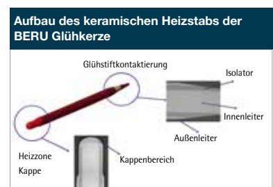
Das Heizelement besteht aus einer elektrisch leitfähigen Vollkeramik. Weil diese an der Oberfläche einen höheren spezifischen Widerstand hat als das Hin- und Rückleitermaterial, glüht der Glühstab nur an der Spitze (Kappe) und erreicht somit schneller hohe Temperaturen. Die Glühstiftkontaktierung setzt sich aus einem Innen- und Außenleiter und einem dazwischen liegenden Isolator zusammen.
