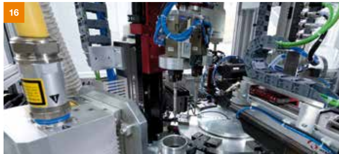
16 Nur Kerzen, die alle Tests bestanden haben, werden zum nächsten Schritt, der Laserbeschriftung, weitertransportiert.
