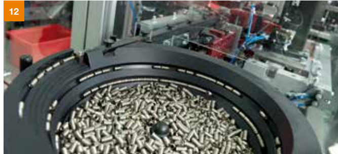
12 Um die flexible Lagerung des Heizstabs zu erreichen, wird das Glührohr von einem Faltenbalg umschlossen. Die Abbildung zeigt die Faltenbalg-Zuführung über einen Fördertopf.
