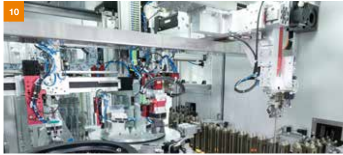
10 Im Logistikmodul werden die Teile vom ersten in den zweiten Fertigungsstrang verbracht, wo zunächst die Vormontage der Vergusskappe stattfindet.
